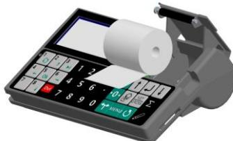
Рис. 2.4 – Заправка бумаги в терминал RC
