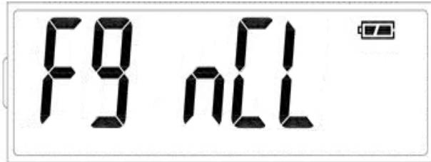
Войдите в данную настройку нажатием на ПДУ весов кнопки «ZERO», после чего на весах выскажется номер калибровки. Этот номер записывается поверителем в п.19 руководства по эксплуатации.
