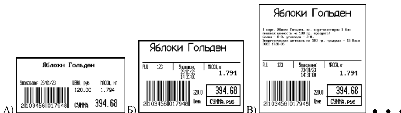
Рис. 2. Пример этикеток, напечатанных по встроенному шаблону (А – 30 мм., Б – 40 мм., В – 60 мм.).
