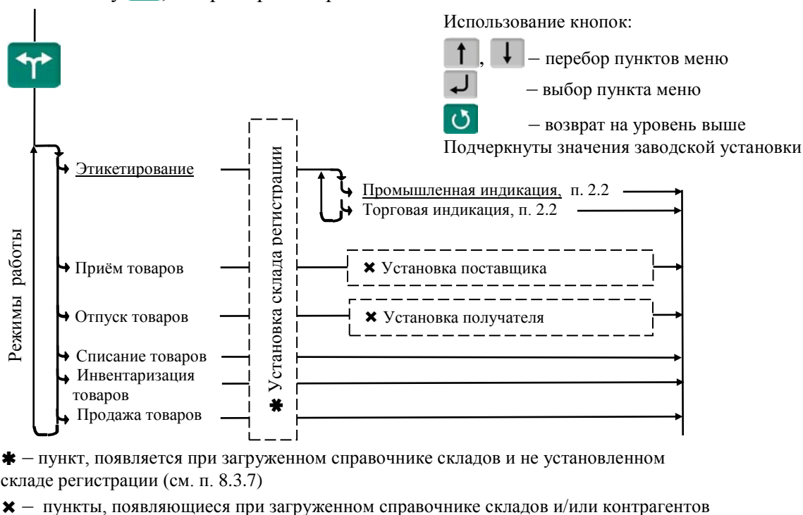
Рис. 4.1 – Меню режимов работы терминала
