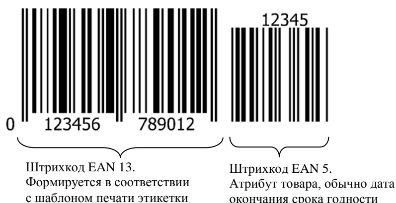
Рис. 7.2 – Структура штрихкода EAN 13+5
