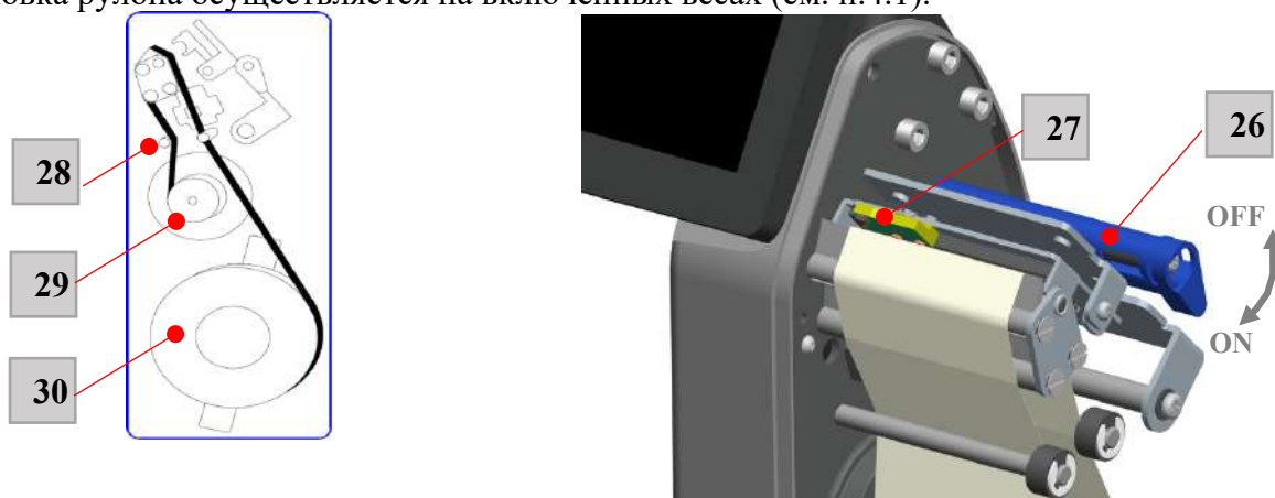
Рисунок 5 – Схема установки рулона этикеток
