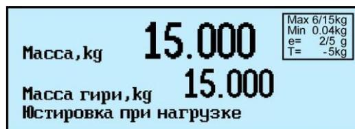
☞ Кнопку ↵ нажимать только после завершения взвешивания. Индикацией завершения является высвечивание на индикаторе сообщения: «Масса, kg».
