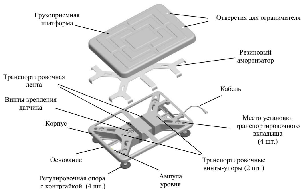
Рис. 4.1 – Модуль взвешивающий ТВ-S\_
